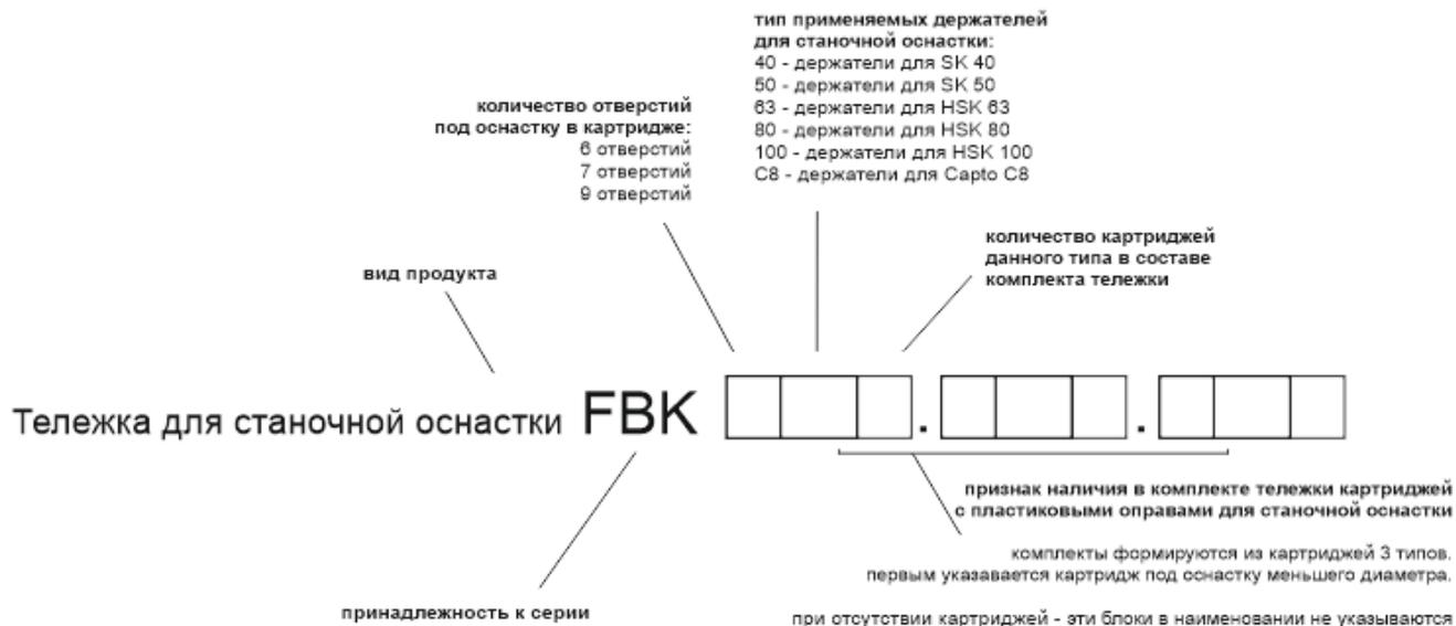
! при применении более 3-х видов картриджей для оснастки тележка не имеет наименования комплекта, а реализуется набором: отдельно «Тележка для станочной оснастки FBK» и отдельно необходимые картриджи с пластиковыми оправами
